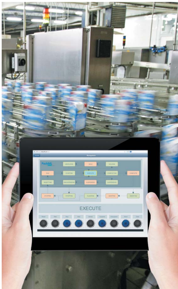
РИС. 1. ► Устройства НМИ, использующие такое программное обеспечение, как Web Studio компании InduSoft, предоставляют мобильным работникам обновленную информацию по мере их перемещения по цеху
