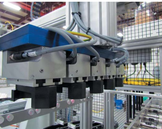
РИС. 5. ▼ Автоматизированный портал имеет два захвата Festo с сервоприводом и V-образными пальцами, смонтированные на пневмоцилиндре Festo. Готовая деталь автоматически подбирается одним захватом и грубо позиционируется вторым. Показан вид сзади захватов с сервоприводом; видны силовые и коммуникационные кабели захватов
