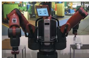
РИС. 2. ▲ Компания Rethink Robotics предлагает Vaxter — простого в программировании и использовании кооперативного робота, который способен безопасно работать в одной зоне с людьми
