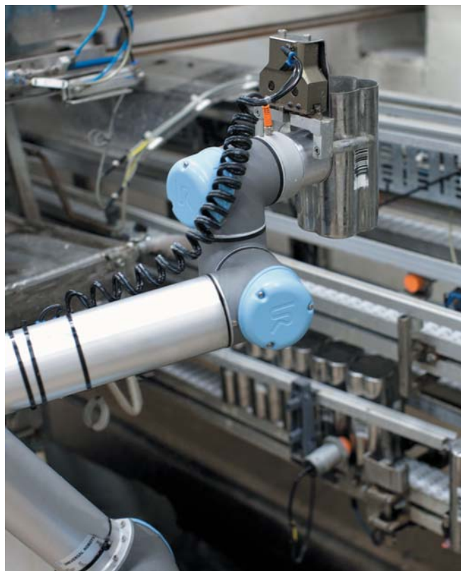
РИС. 3. ▼ Робот UR5, установленный перед конвейерной лентой, держит в своем захвате банку с сахарным сиропом. Процесс взятия образцов автоматизирован с использованием трех роботов UR5
