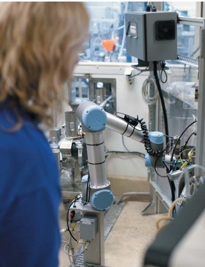
РИС. 4. ▲ Сотрудник без защитного ограждения контролирует работу робота, анализ содержимого банки и его розлив по фильтрам
