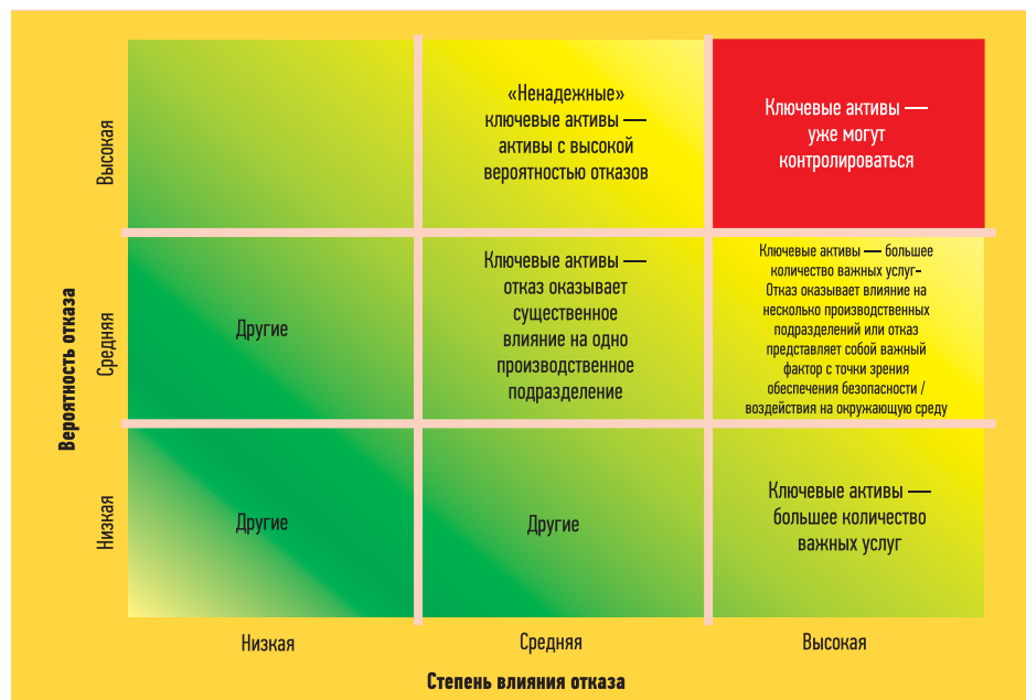
РИС. 2. ▼ Ключевые активы обычно не имеют уже установленных систем контроля, но последствия их отказов могут быть серьезными
