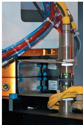
« В «умной ячейке» компании Sopaу (это гибкий сборочный узел для головок цилиндров) два манипулятора-робота действуют попеременно. Если один работает на сборочном узле, то другой подготавливает следующий этап, устанавливая требуемый инструмент. Индуктивные соединители с интерфейсом IO-Link передают мощность в 12 Вт на блок смены инструмента. Данные от датчиков передаются в обратном направлении.
