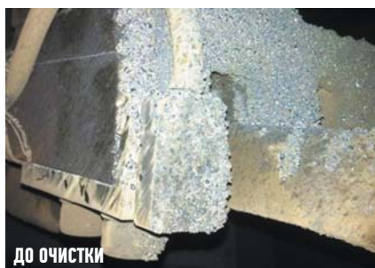
Брызги после одного прохода сварки
