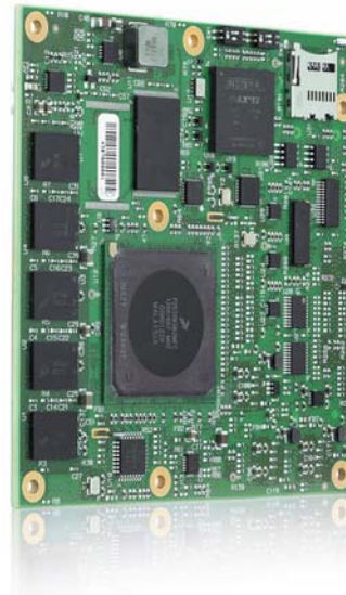
◀ Модуль COM Express (форм-фактор basic) компании Kontron, выполненный на базе 32-битного процессора Freescale QorIQ P2020. В стандартном исполнении устройство рассчитано на эксплуатацию в температурном диапазоне 0...+60 °С, в защищенном — -40...+85 °С
