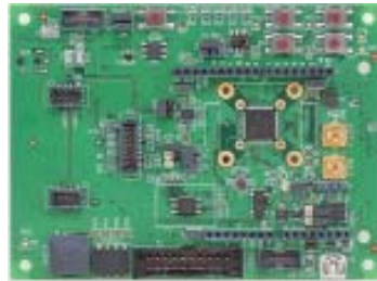
РИС. 3. ◀ Плата оценочного набора EVAL-ADuCM3029 EZ-KIT (вид сверху)
