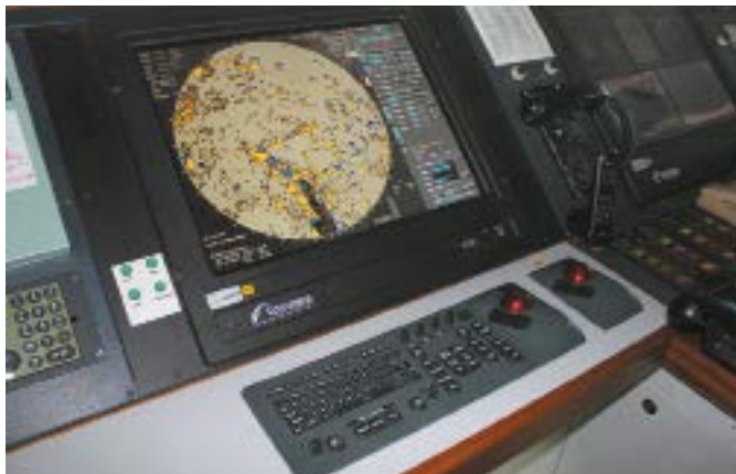
Многофункциональная рабочая станция Navi-Sailor 4000 ECDIS MFD
