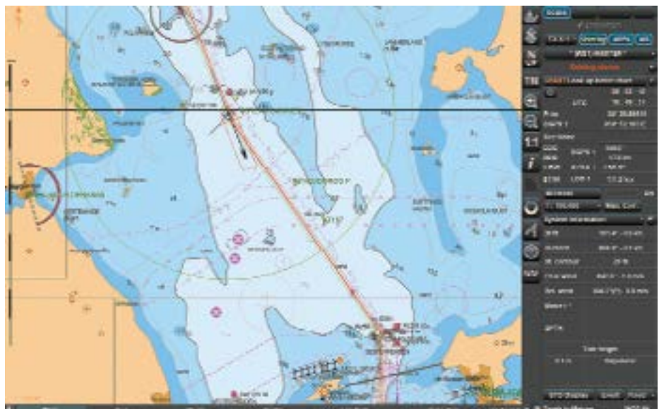
Отображение электронной карты на экране ЭКНИС с наложением радарного изображения
