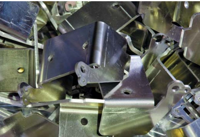
▲ Кронштейны после гибки и оцинковки
