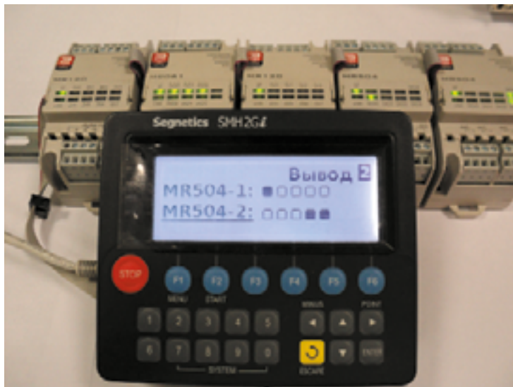
РИС. 4. ПЛК Segnetics SMH2Gi с графическим интерфейсом ISaQt
