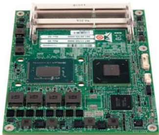
РИС. 1. ◀ «Компьютер-на-модуле» стандарта COM-Express: RadiSys CEQM77 с процессором Intel Core 17 IvyBridge
