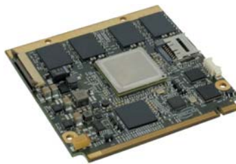
РИС. 2. ▶ «Компьютер-на-модуле» стандарта Qseven: SECO QuadM6747-X/i.MX6 с процессором Freescale iMX6
