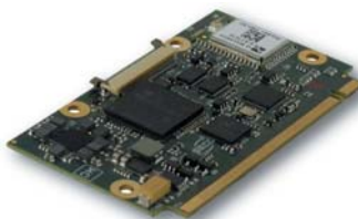
РИС. 3. ▶ «Компьютер-на-модуле» стандарта Qseven: SECO uQ7-OMAP5 40×70 мм с процессором Texas Instruments OMAP5
