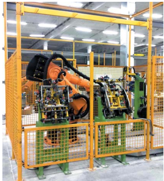
РИС. 2. ▼ РТК со стационарными столами и грейферами с зажимной оснасткой и быстроразъемными соединениями сварки передних сидений ВА3-2190
