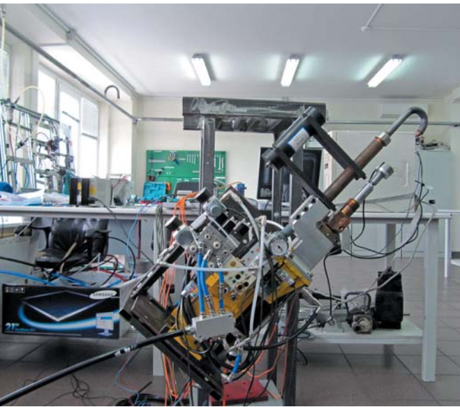
РИС. 9. ▲ Стенд для испытания сварочных клещей
