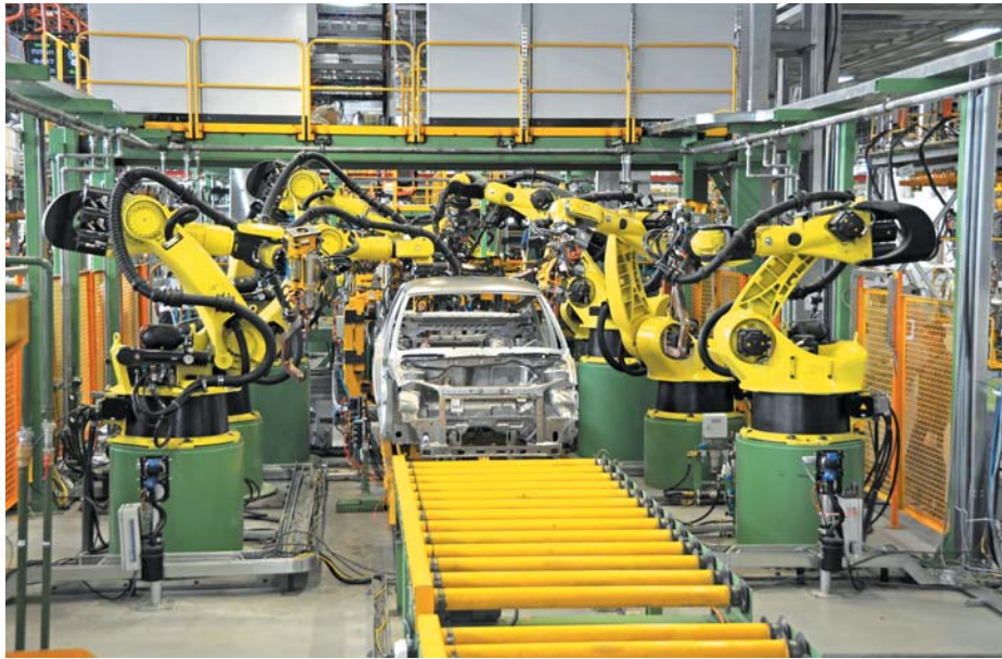
РИС. 3. ▲ Автоматическая линия контактной точечной сварки кузова автомобиля ВАЗ-2190
