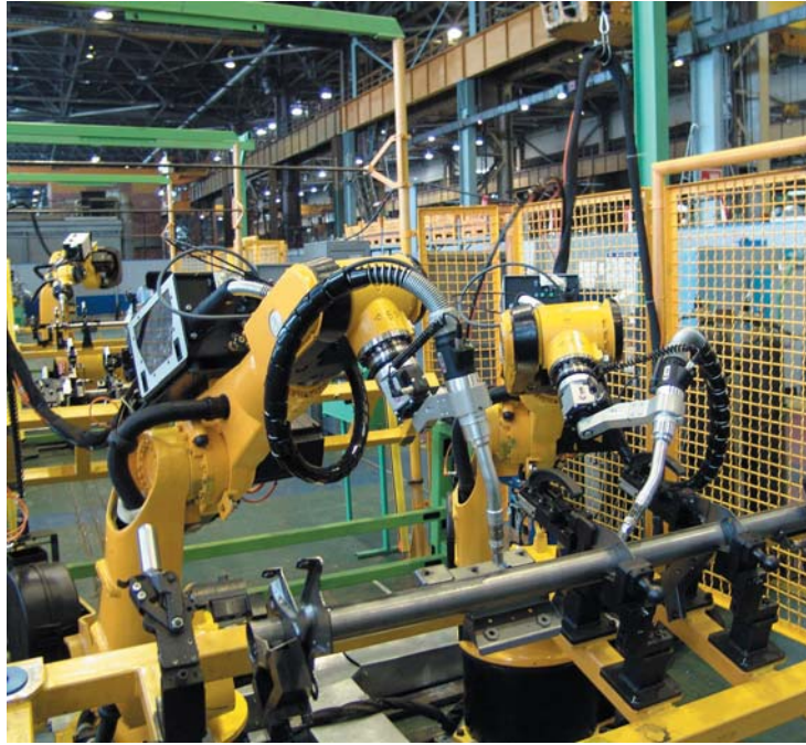
РИС. 1. ◀ РТК дуговой сварки поперечины панели приборов ВА3-2190
