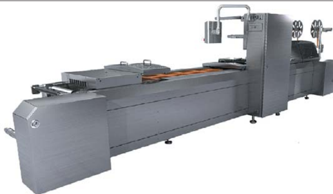
РИС. 6. ◀ I-Series Thermoformer (вид сзади): сегменты формирования, запечатывания и разгрузки (слева направо)
