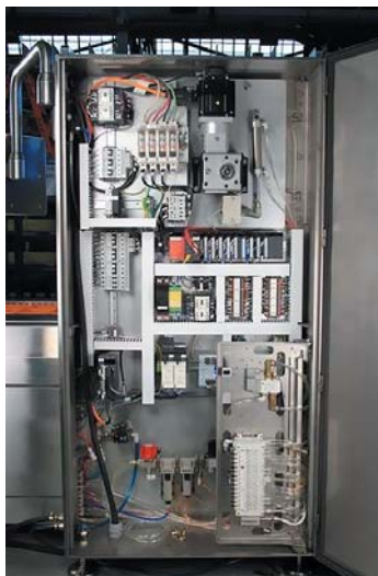
РИС. 5. ◀ I-Series Thermoformer от компании VC999 Packaging Systems использует CC-Link IE Field Ethernet для соединения ПЛК и других систем автоматизации в этой станции
