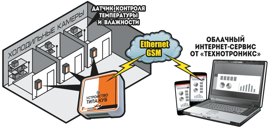
РИС. 3. ▶ Схема устройства системы мониторинга «ТехноТроникс»
