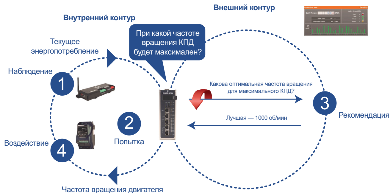
РИС. 1. ▼ Преимущества модели автоматизации, сочетающей надежное детерминированное управление с усовершенствованными вычислениями. Изображение предоставлено компанией Emerson
