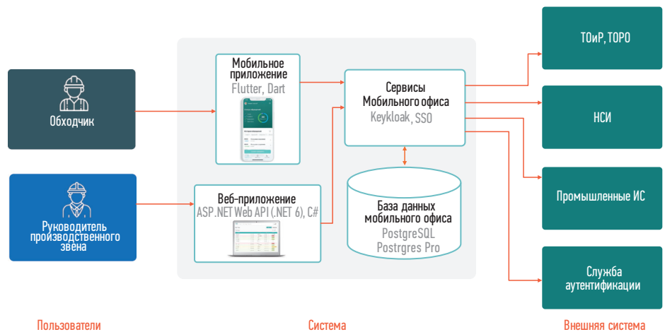
РИС. 3. ▲ Архитектура АРМ обходчика
