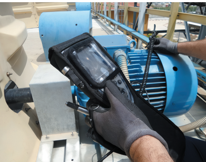
РИС. 1. ▼ Осмотр оборудования вручную с помощью пьезодатчиков и портативного регистратора
