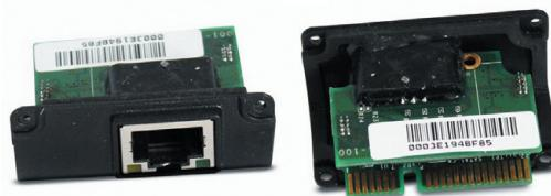
**Рис. 1.** Аппаратные модули расширения для планшета Algiz 8X
