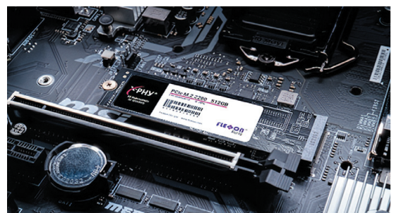
РИС. 5. ▼ Установка X-PHY SSD на материнской плате
