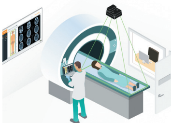
РИС. 5. ◀ Определение точного положения пациента для обеспечения максимального качества рентгеновского снимка. Автоматическое позиционирование с точностью до миллиметра позволяет получать точные снимки и сводит к минимуму необходимую дозу облучения
