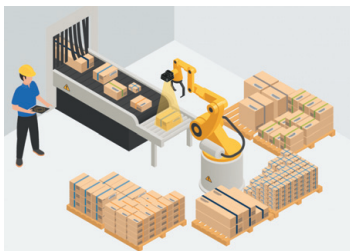
РИС. 2. ▶ Определение формы, положения и ориентации груза, который необходимо уложить на поддон, а также вычисление оптимальной такелажной точки подъема
