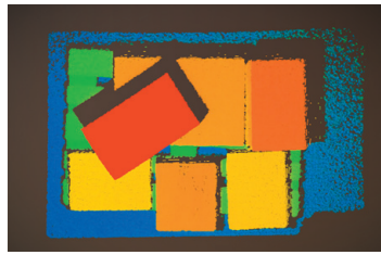
РИС. 7. ▶ Изображение, полученное при помощи ToF-камеры
