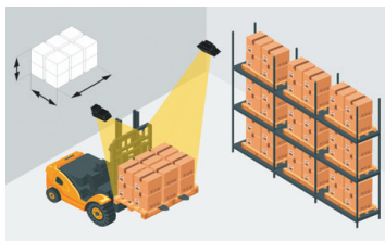
РИС. 1. ◀ Определение габаритов поддонов и упаковочной тары
