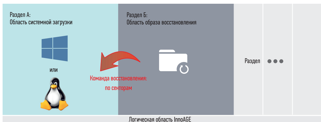
Рис. 6. ► SSD, разбитый на разделы для реализации возможности восстановления в будущем
