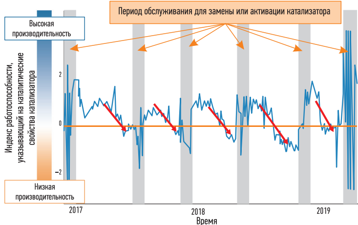
РИС. 2. ► График индекса состояния катализатора показывает, когда износ достигает точек, при которых качество продукта недопустимо ухудшается. Точки показаны красными стрелками, а серые полосы на рисунке показывают моменты времени, в которые процесс синтеза бензола останавливался для замены катализатора. Изображение предоставлено корпорацией Yokogawa Electric Corporation
