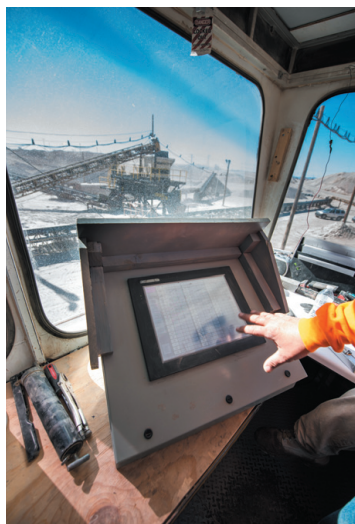
РИС. 1. ► Цифровые HMI, такие как C-more от компании AutomationDirect, занимают меньше места при установке, чем обычные вспомогательные устройства для управления, и обеспечивают более простой для разработчиков и более понятный для конечных пользователей интерфейс. Изображение предоставлено компанией AutomationDirect
