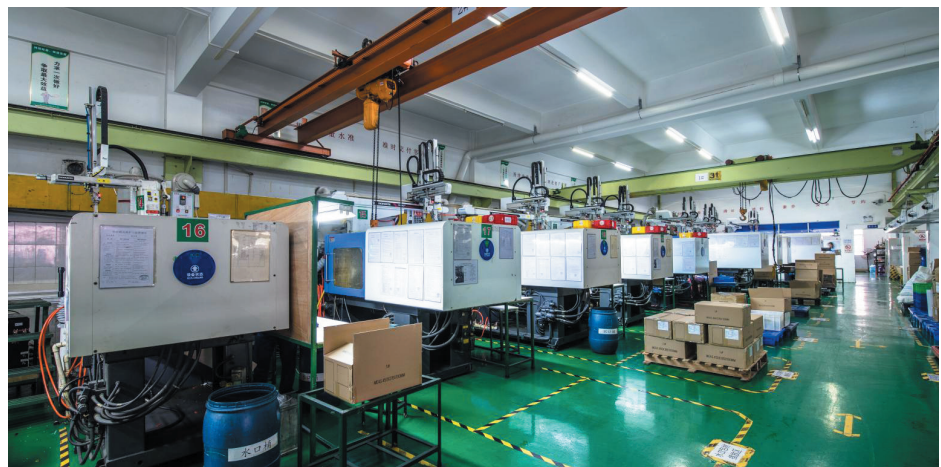
РИС. ▼ Для быстрого перехода на продукцию для нужд здравоохранения наиболее целесообразно использовать термопластавтоматы. Источник изображения: компания Fictiv
