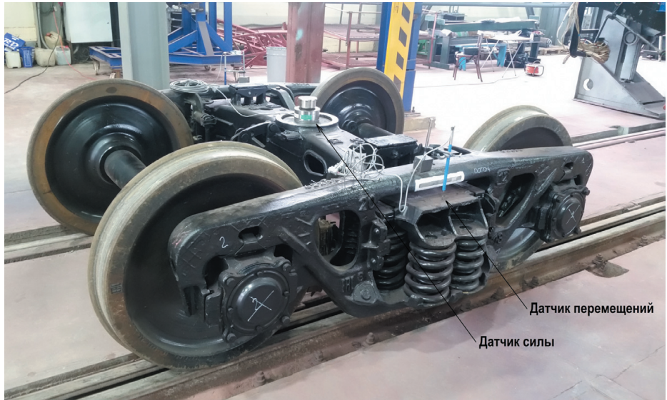
РИС. 6. ▲ Телетка грузового вагона, оборудованная различными типами датчиков
