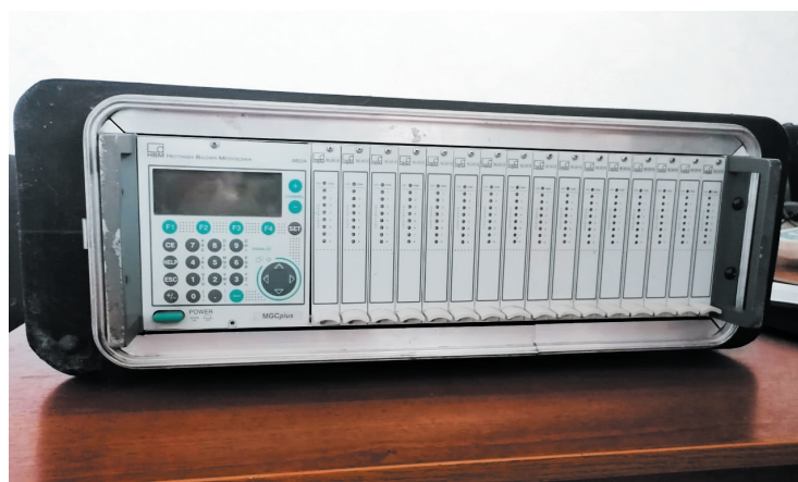
Рис. 3. ◀ Общий вид тензометрической системы MGC+ для подключения первичных преобразователей (128 измерительных каналов)
