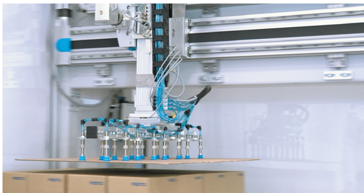
РИС. 5. ◀ Перемещение межслойной гофропрокладки
