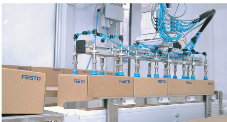
РИС. 3. ◀ Выравнивание ряда на подающем транспортере
