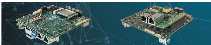
Установка плат расширения Wi-Fi и Bluetooth через M.2 2230 Установка плат расширения 4G/LTE через PCIe
