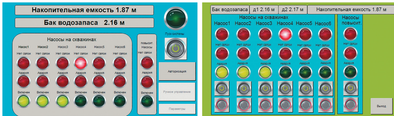
РИС. 2. ▲ Мнемосхемы состояния исполнительных механизмов
