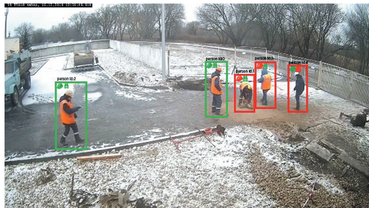
РИС. 1. ◀ Пример работы модуля обнаружения людей и контроля использования СИЗ
