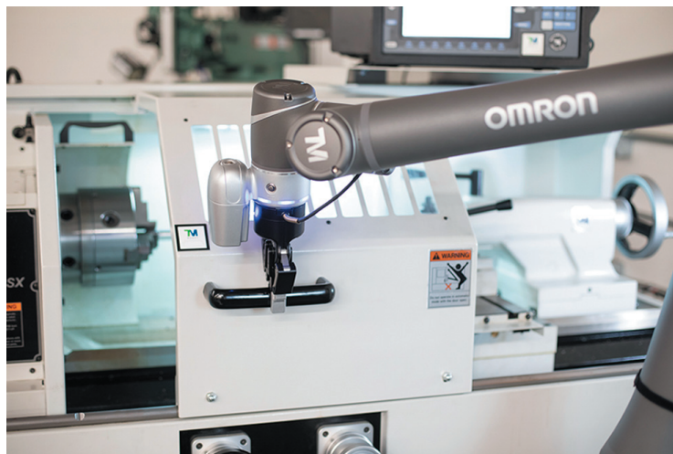
РИС. 1. ▶ Коллаборативные роботы используют датчики обратной связи по силе и несколько осей движения для выполнения операций по обслуживанию оборудования, таких как закрытие дверцы станка с ЧПУ с помощью захвата. Все изображения предоставлены Omron Automation Americas
