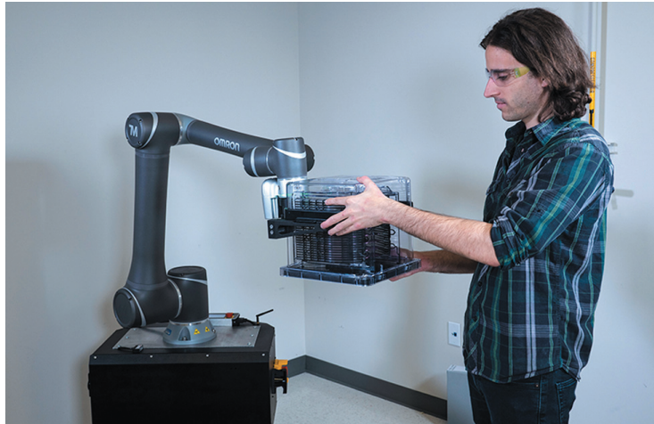
РИС. 2. ◀ Легкие и разработанные с закругленными кромками коллаборативные роботы специально предназначены для работы рядом с человеком-оператором
