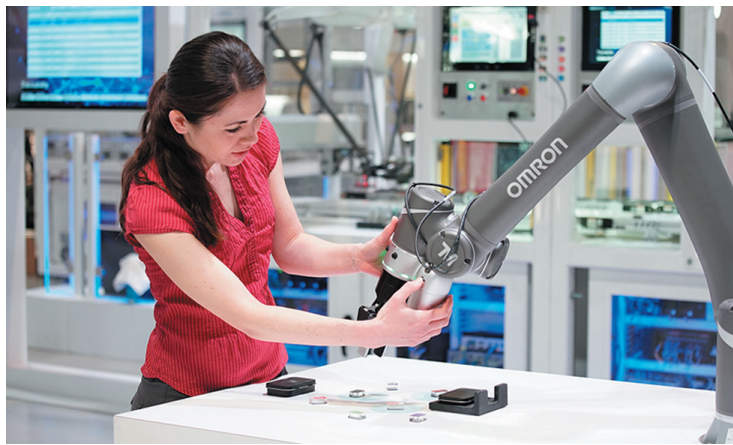
РИС. 3. ◀ Гибкая рука многих совместных коллаборативных роботов может быть оснащена широким набором рабочих органов и легко обучена новым задачам с помощью обучения с ручным управлением
