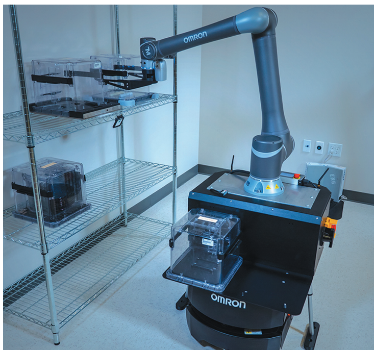
РИС. 4. ◀ Коллаборативные манипуляторы могут устанавливаться на мобильной базе для выполнения задач «забирай и неси»
