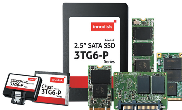
РИС. 3. Серия 3D NAND флэш-памяти индустриального класса от компании Innodisk
