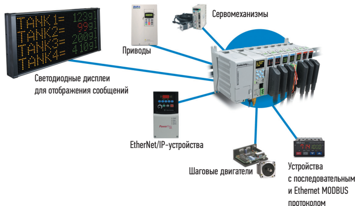
РИС. 1. Эффективность производства зависит от сбора данных. Коммуникационные возможности и возможности обработки данных этого контроллера серии AutomationDirect Productivity позволяют подключаться ко многим различным устройствам. Все рисунки предоставлены компанией AutomationDirect
