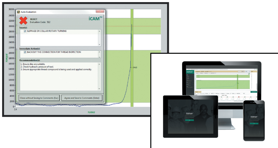
РИС. 4. ▲ Технология интеллектуального анализа соединения монтажа колонны труб трубной обвязки, вынесенная на экран, и дисплей с его отображением
