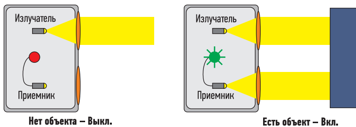
РИС. 1. ▶ Дискретный фотоэлектрический датчик, работающий на отражение, сообщает, измерено ли заданное значение (характеристика), идентифицирующее объект
