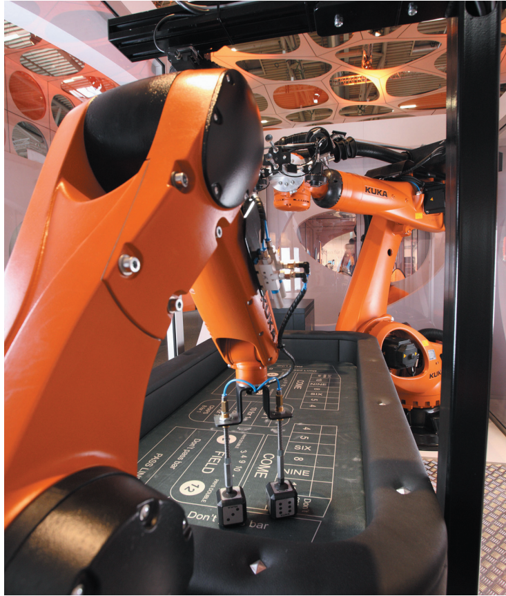
РИС. 2. ◀ Робот KUKA KR Agilus с приводами Kollmorgen выполняет функции укладчика
