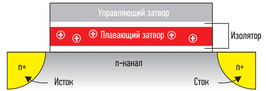
РИС. 1. ▲ Транзистор с плавающим затвором
