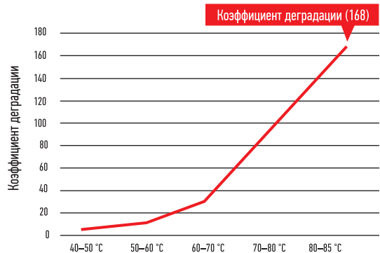
РИС. 2. ▼ Изменение коэффициента деградации при повышении температуры
