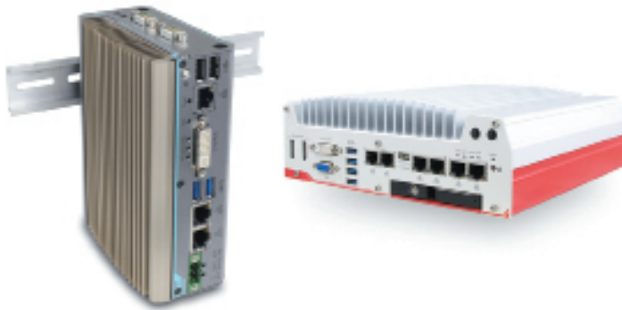
РИС. 7. ▶ Промышленные безвентиляторные компьютеры — залог надежной работы
