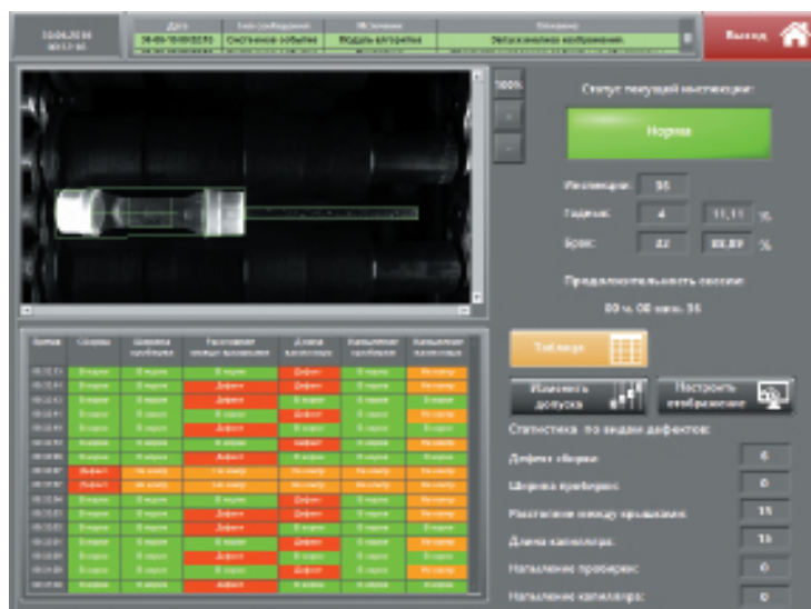
РИС. 6. ◀ Система контроля сборки пробирки
