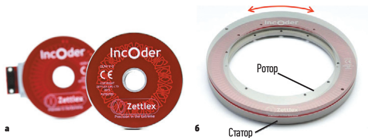
РИС. 3. ◀ Индуктивный бесконтактный угловой датчик IncOder от Zettlex: а) миниатюрный энкодер IncOder с внешним диаметром 58 мм; б) расположение статора и ротора энкодеров Zettlex относительно друг друга
