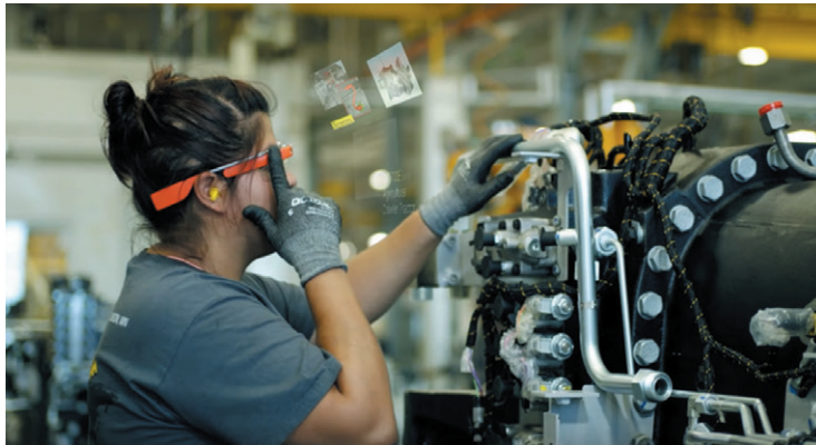
РИС. 7. ► Оператор собирает двигатель трактора с помощью Google Glass
