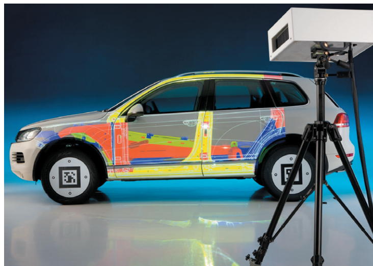
РИС. 6. ◀ Демонстрация внутренних деталей автомобиля Volkswagen с помощью проекционного AR-оборудования
