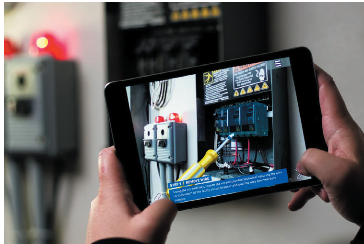
РИС. 5. ◀ Использование планшета для наблюдения за ремонтом оборудования с элементами AR
