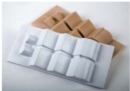
РИС. 4. ▼ Изделия, произведенные вакуумной формовкой по оснастке из керамонаполненного пластика PLASTCure Rigid 10500
