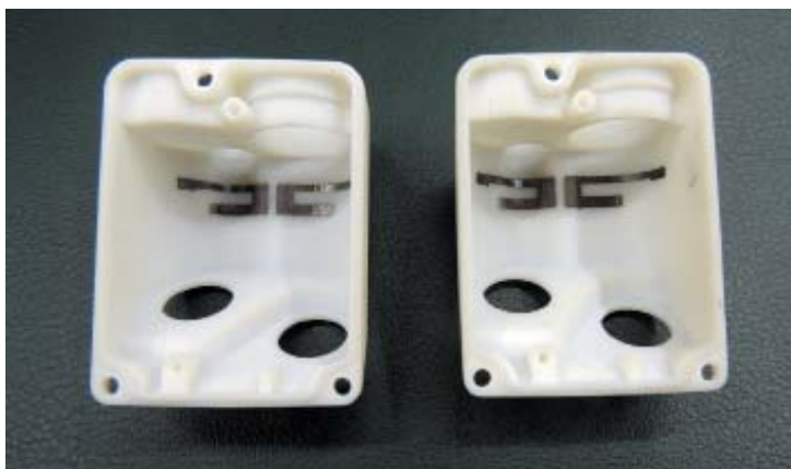
РИС. 6. ► Пример прототипа корпуса с нанесенной на него рабочей Wi-Fi-антенной
