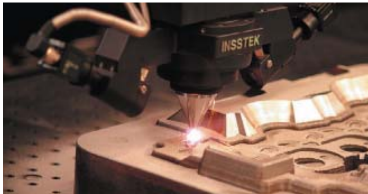
РИС. 8. ▲ Функциональная схема 3D-печати по технологии DMT
