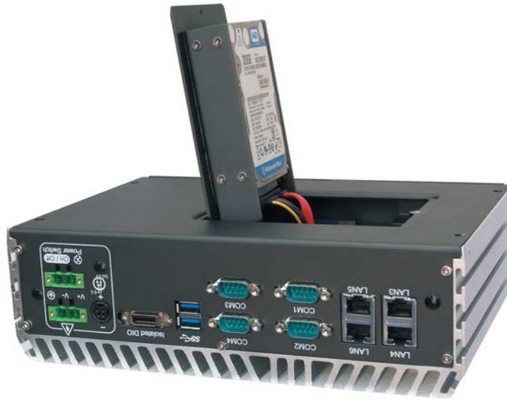
РИС. 2. ◀ Встраиваемый компактный безвентиляторный компьютер ECS-7000 для транспорта
