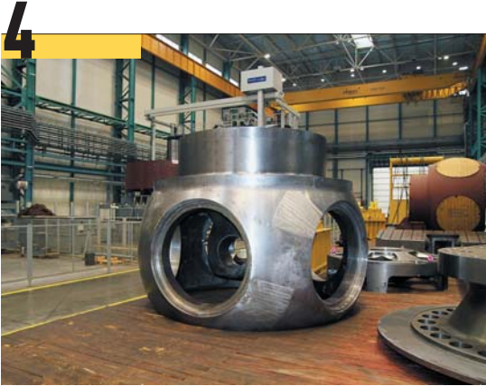
4 Корпуса рабочих колес гидротурбин ожидают очереди на механическую обработку и последующую сборку для поставки на одну из ГЭС.
