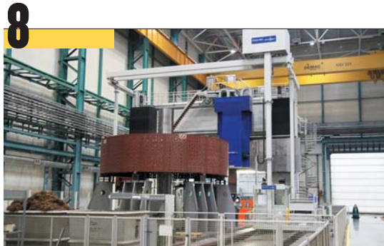
8 Самый большой фрезерный станок портального типа в Санкт-Петербурге. Рабочее поле составляет 20×7 м, и при этом точность обработки остается на уровне 30 микрон (0,03 мм). На этом станке производится механическая обработка корпусов цилиндров паровых турбин.
