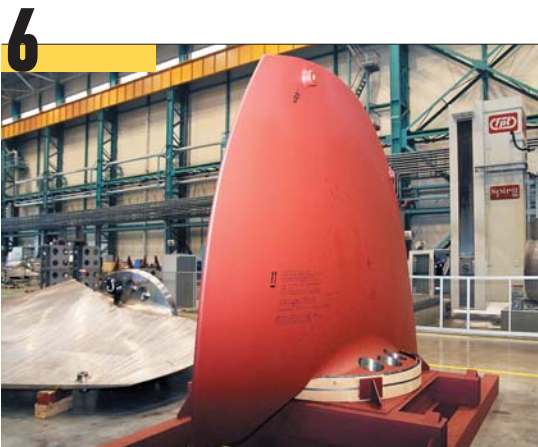
6 Готовая к отгрузке лопасть гидротурбины для установки на Воткинской ГЭС.
