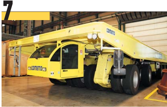
7 На предприятии имеется собственный самоходный транспортировщик от итальянской компании Cometto грузоподъемностью 325 тонн. Применяется при транспортировке крупногабаритных изделий (роторов, корпусов и пр.).
