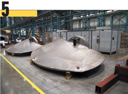
5 Лопasti гидротурбин на временном складировании ожидают своей очереди на механическую обработку, сборку и покраску.
