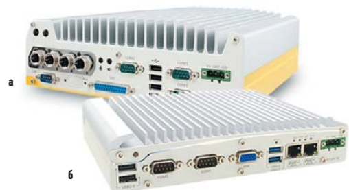
РИС. 7. ▼ Компьютеры, предназначенные для работы в транспортных средствах: а) Nuvo-5100VTC; б) Nuvo-2500
