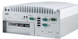
РИС. 5. ▲ Отсек расширения для установки двух или шести слотов расширения (серия Nuvo-6000)
