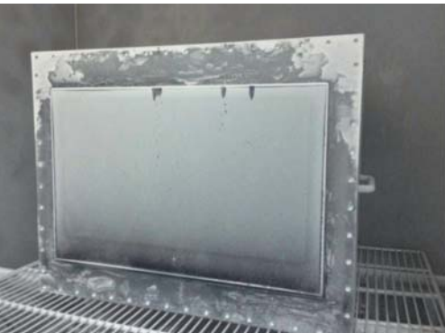
РИС. 2. ▲ Тестирование защиты промышленного дисплея от воды и пыли
