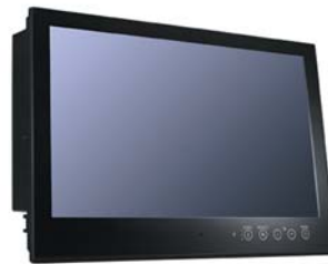
РИС. 4. ◀ Мохэ MD-224X, 24-дюймовый дисплей для морских применений с разрешением fullHD, соответствующий ECDIS
