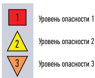
РИС. 3. ▶ Аварийные сигналы, дифференцированные по уровню тяжести последствий: 1) высокий; 2) средний и 3) низкий
