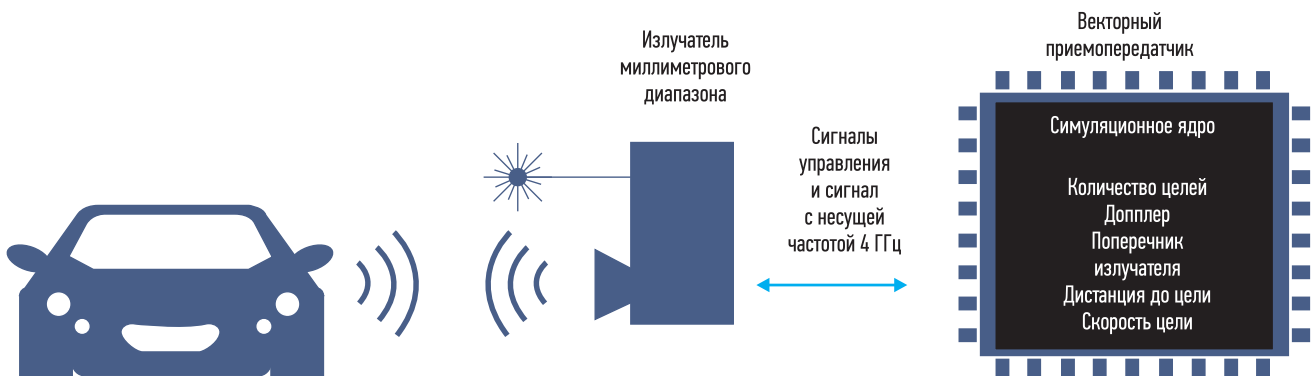
РИС. 4. ▼ Блок-диаграмма радарной системы с миллиметровым излучателем
