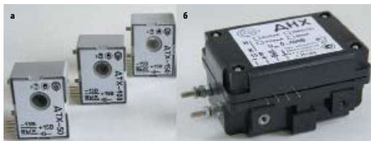
РИС. 1. ► Общий вид датчиков тока ДТХ (а) и датчиков напряжения ДНХ (б) для монтажа на печатную плату
