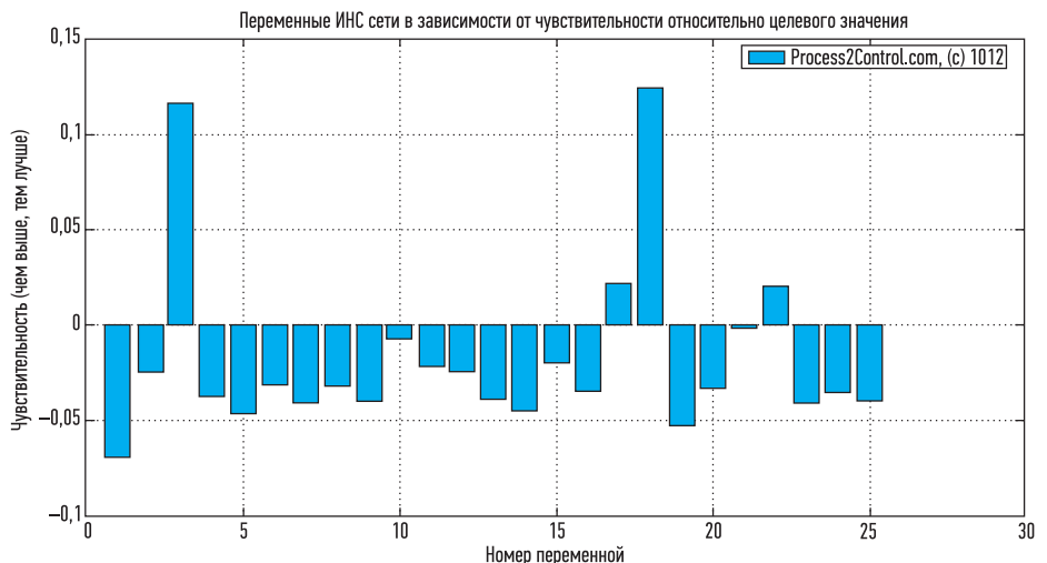
РИС. 5. ▼ График анализа значимости входов ИНС показывает входы, вклад которых выше нуля. Входы ниже нуля либо незначительны, либо находятся на уровне помехи
