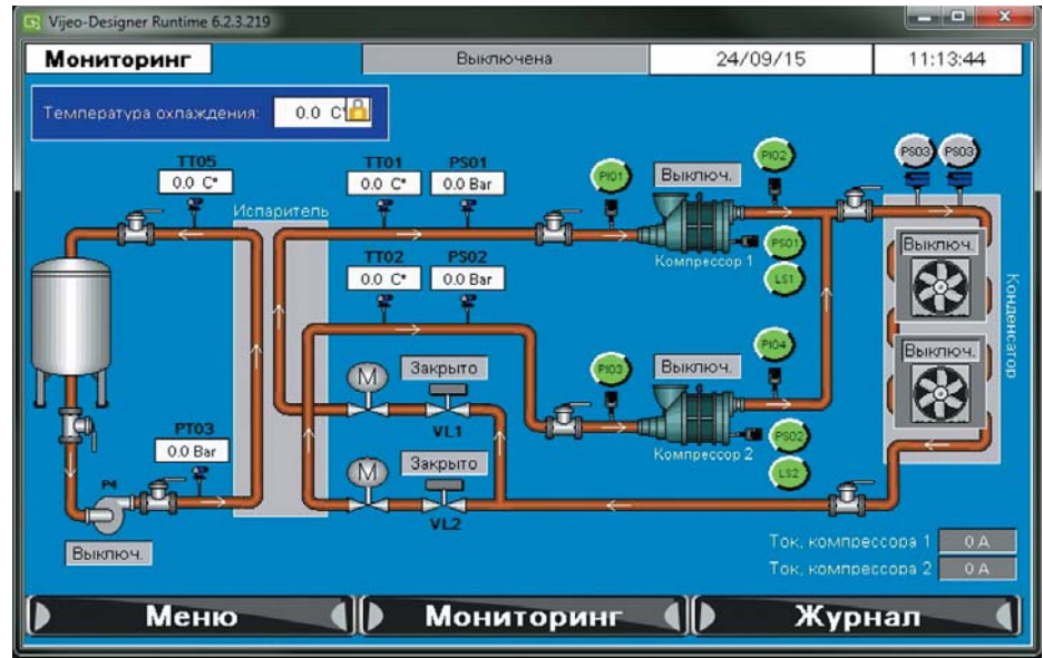
Рис. 1. ▲ Мнемосхема чиллера с гидромодулем на панели БХО
